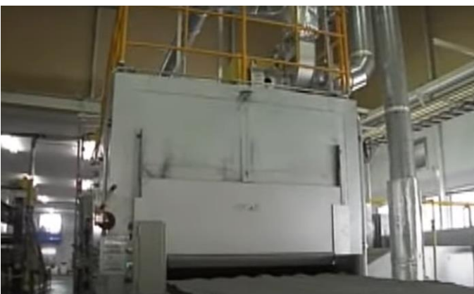
3. 加熱した後圧力を加え冷却します。
