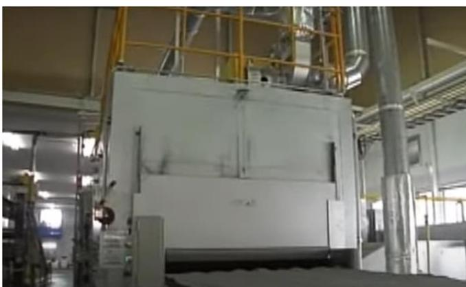
3. 加熱した後圧力を加え冷却します。
